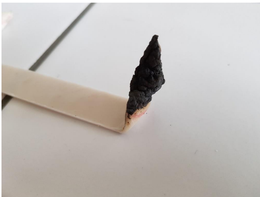
Obr. 22: vzniklá zuhelnatělá vrstva u intumescentního retardéru
