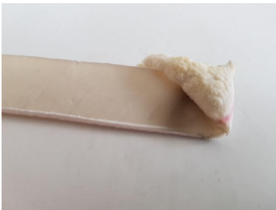
Obr. 23: vzniklá keramická vrstva u Apyralu 20X
