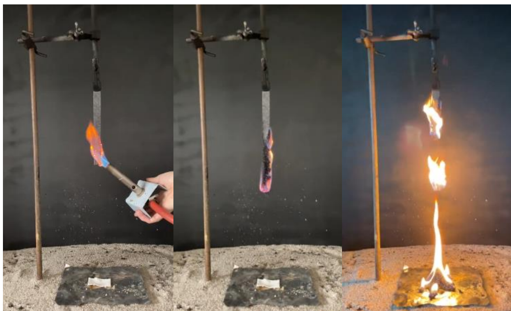
Obr. 24: záznam vertikálního hoření pro vzorek s expandovatelným grafitem o koncentraci 8 %
