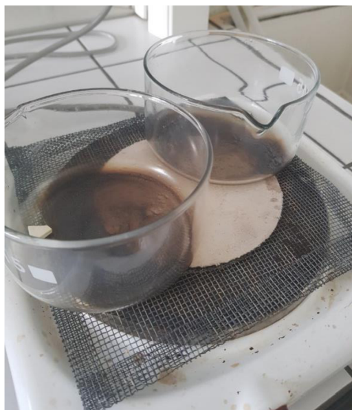
Obr. 19: odpařování rozpouštědla na varné desce
