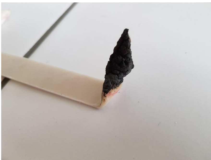
Obr. 22: vzniklá zuhelnatělá vrstva u intumescentního retardéru
