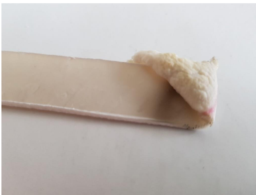
Obr. 23: vzniklá keramická vrstva u Apyralu 20X
