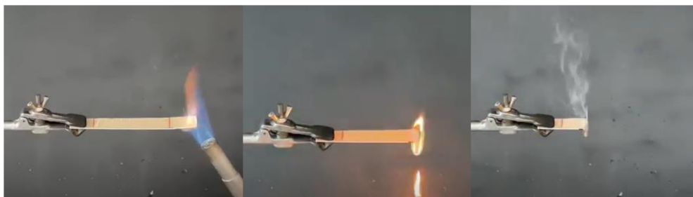
Obr. 20: záznam horizontálního hoření pro vzorek s Exolitem AP 422 o koncentraci 30 %
