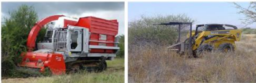
Obr. 11: Sklizeč křovin s korbou (vlevo), univerzální sklizeč křovin (vpravo) Zdroj [2]
