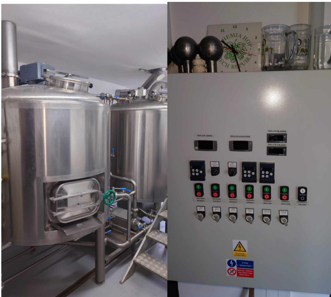
Obrázek 8 a 9: Varna a ovládací panel varny.
