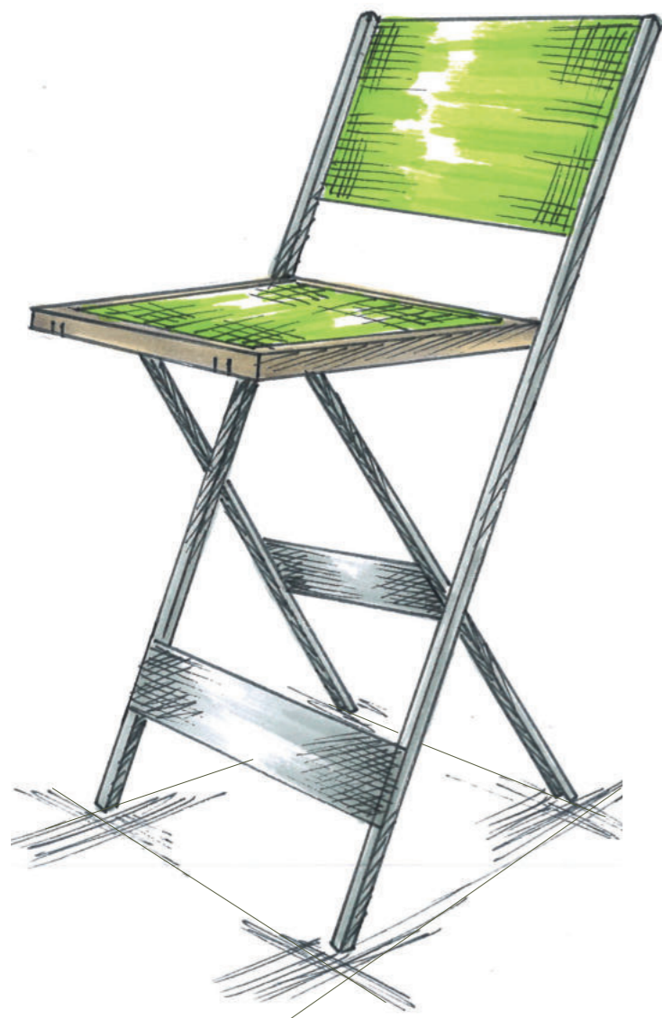
stejná konstrukce s použitím dvou materiálů kovové nohy, dřevěný rám sedáku
