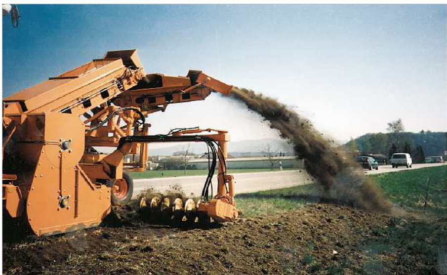
Obr. 7: Fréza DÜCKER BF 900 vybavena odřezávacím šroubem a dopravníkem pro odhoz odfrézovaného materiálu [10]
