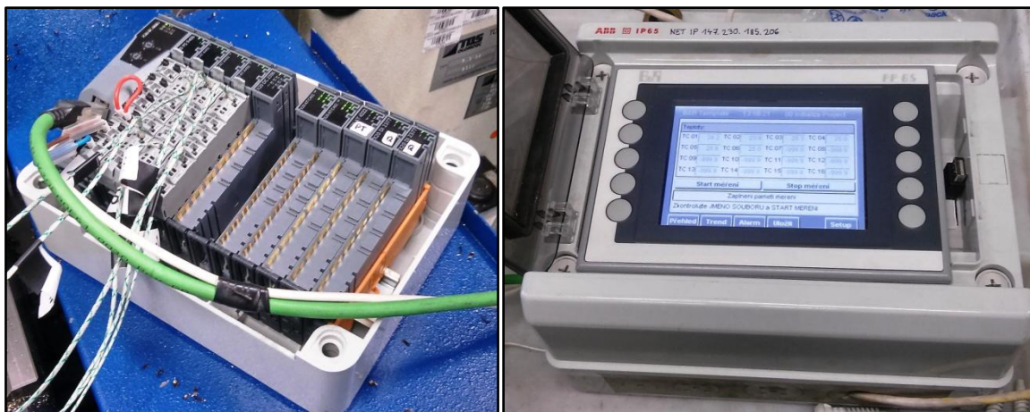
Obr. 33 Termočláanky zapojené ve sběrnici (vlevo), provozní jednotka (vpravo).
