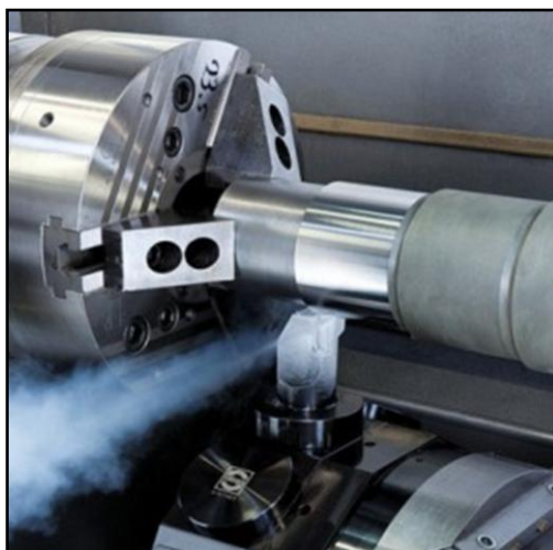
Obr. 13 Chlazení břítu nástroje tekutým dusíkem - nepřímé chlazení [7].
