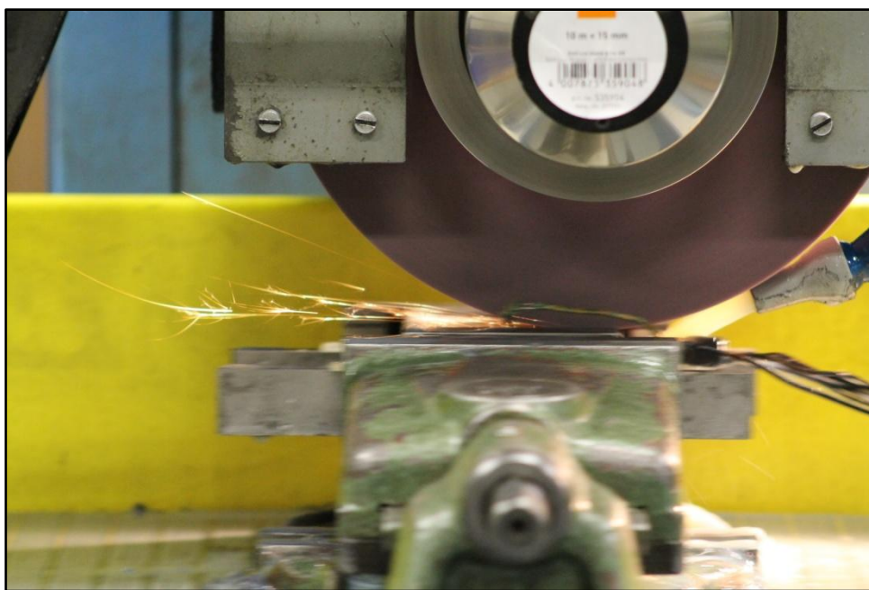
Obr. 40 Broušení s využitím procesních kapalin
