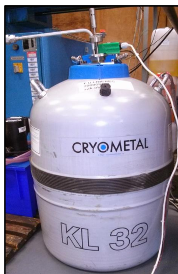
Obr. 12 Zásobník typu KL, 32litrů od firmy CRYOMETAL s.r.o.
