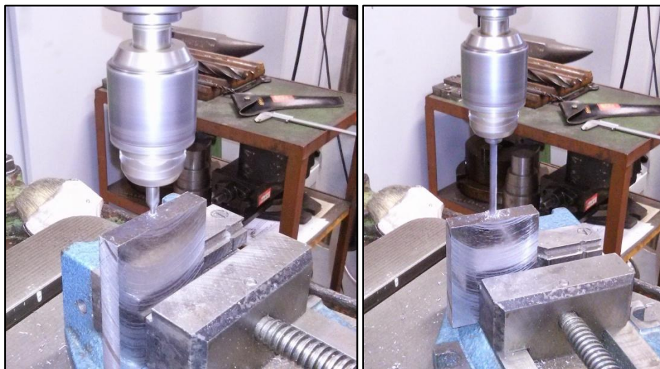
Obr. 27 Navrtávání (vlevo) a vrtání (vpravo) otvoru do čela vzorku.
