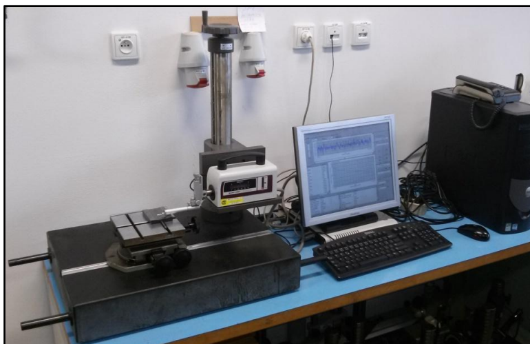
Obr. 19 Profiloměr Mitutoyo Surftest SV - 2000 N2.
