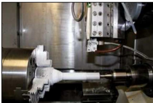
Obr. 11 Přívod CO 2 ve formě tryskaného sněhu [7].
