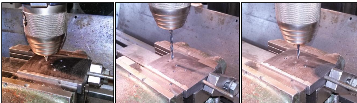
Obr. 30 Navrtání důlků (vlevo), vrtání otvorů (ve středu), frézování kuželu (vpravo).
