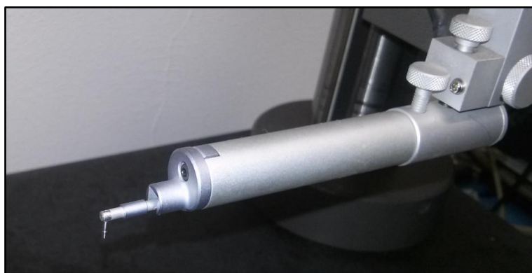
Obr. 20 Dotek s diamantovou kuželovou špičkou.
