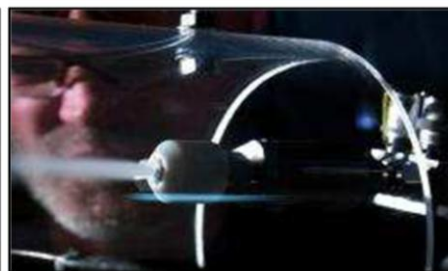
Obr. 11 Přívod CO 2 ve formě tryskaného sněhu [7].
