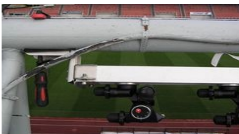
Obrázek 29. Připevnění kamer na rám
