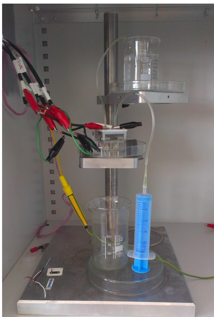
Obrázek 9 - Měřící aparatura s průtočnou celou umístěná ve Faradayově kleci
