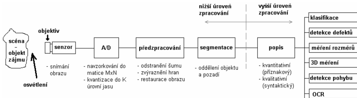
Obrázek 11: Řetězec snímání a zpracování obrazu [16]
