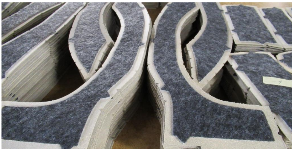
Obrázek 3: Příklad laminátu kůže, polyuretanu o tloušťce 2 mm a netkanou textilií
