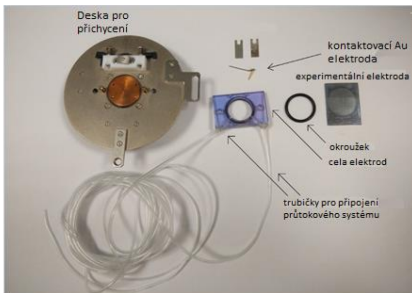
Obr. 20: komponenty elektrochemické cely
