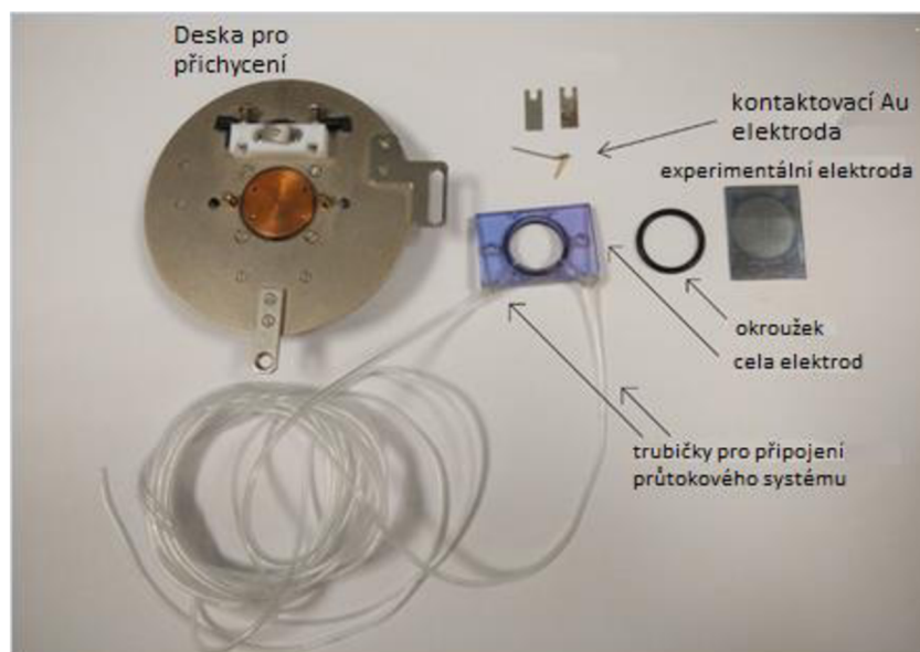
Obr. 20: komponenty elektrochemické cely
