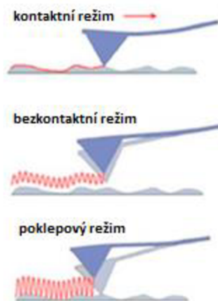
Obr. 14: měřící režimy v AFM [19]
