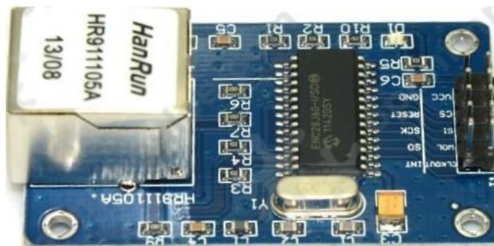
Obr. 6-3 Ethernetový modul s obvodom ENC28J60.
