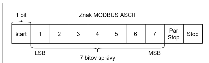
Obr. 3-3 Sekvencia bitov, znaku MODBUS ASCII [4]
