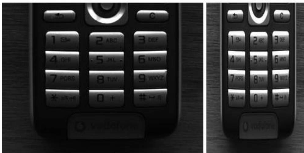
Obrázek 2.12 Binning – slučování pixelů[28]
