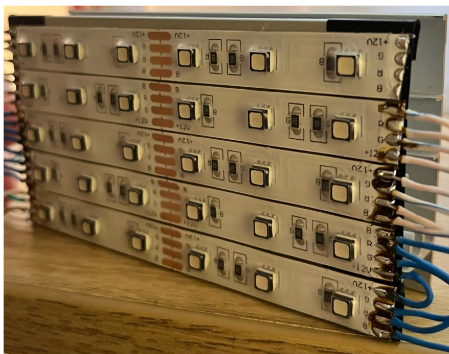
Obrázek 3.5 Zdroj světla pro kopulovité osvětlení
