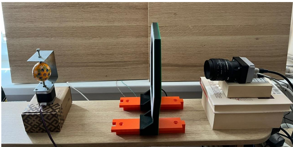
Rozvržení systému – osvětlení kruhové
