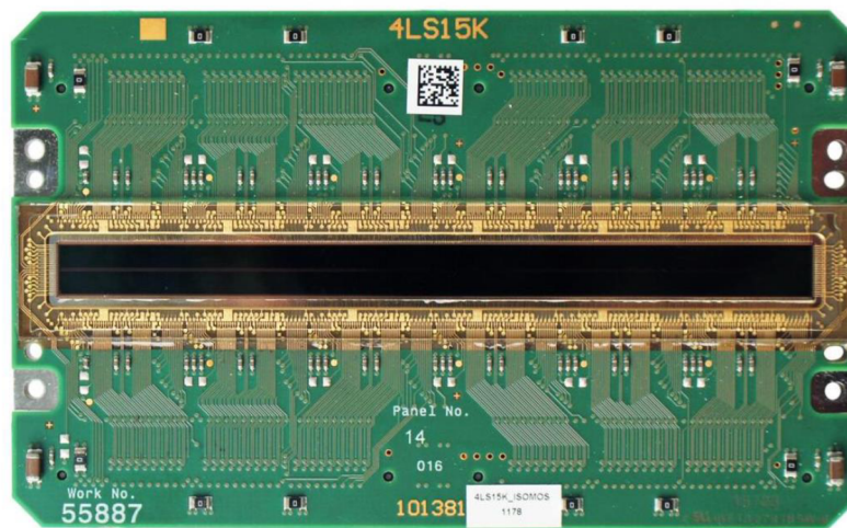
Obrázek 2.3 řádkový (line scan) snímač obrazu [6]
