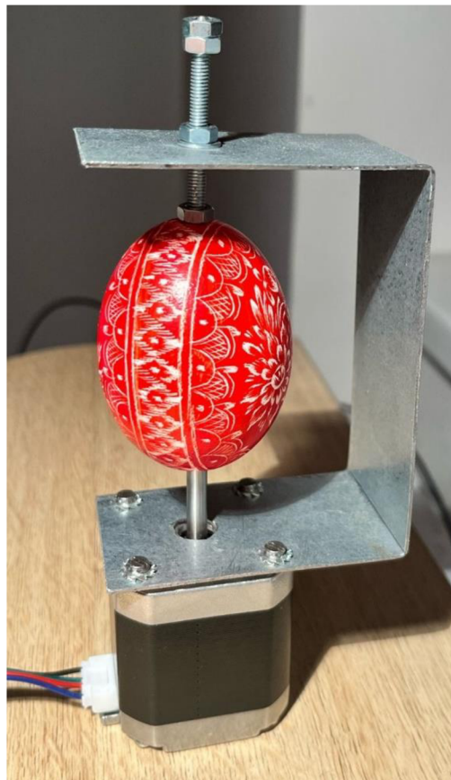
Obrázek 3.10 Přípravek pro uchycení kraslice
