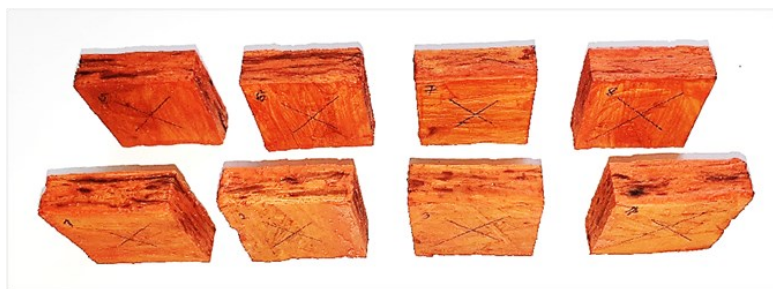
Obrázek č. 17: Vzorky opatřené povrchovou úpravou 7 – adhezním můstkem po zkoušce cyklováním
