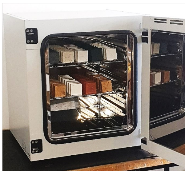
Obrázek č. 10: Zkušební vzorky uložené v sušárně při zkoušce cyklováním [Zdroj: Vlastní zpracování]
