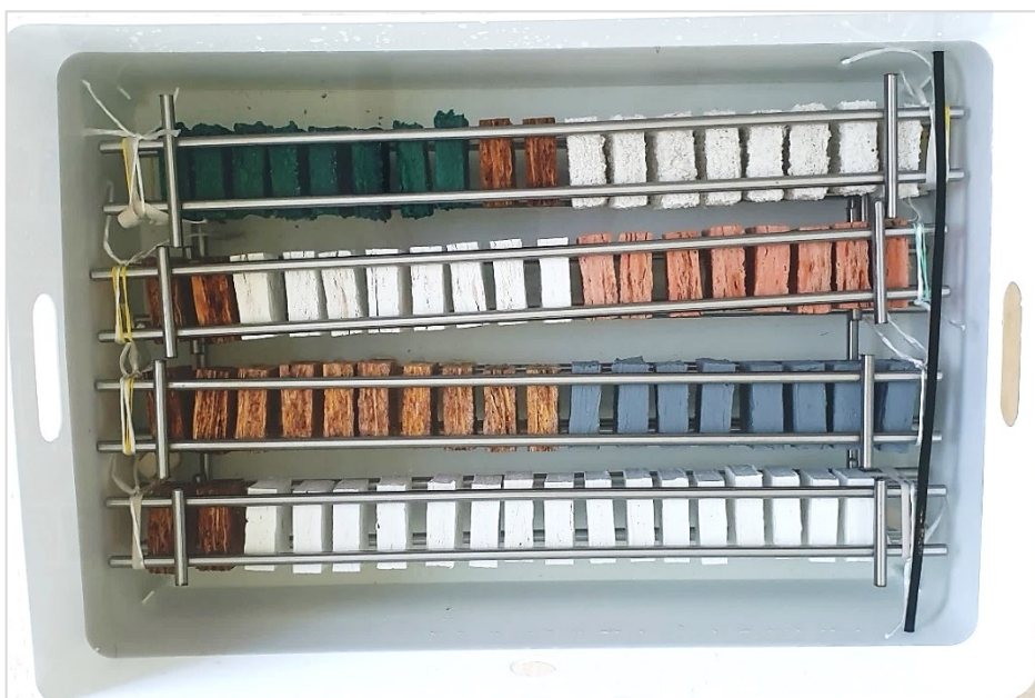
Obrázek č. 6: Zkušební vzorky ponořené ve vodě při zkoušce stanovení bobtnání [Zdroj: Vlastní zpracování]
