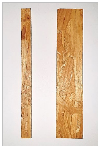
Obrázek č. 3: Příklad zkušebních vzorků bez povrchové úpravy pro zkoušky vztlínáním [Zdroj: Vlastní zpracování]
