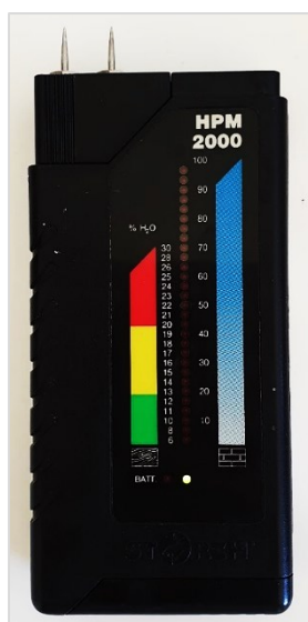
Obrázek č. 14: Vlhkoměr používaný při nedestruktivní zkoušce vztlínání [Zdroj: Vlastní zpracování]
