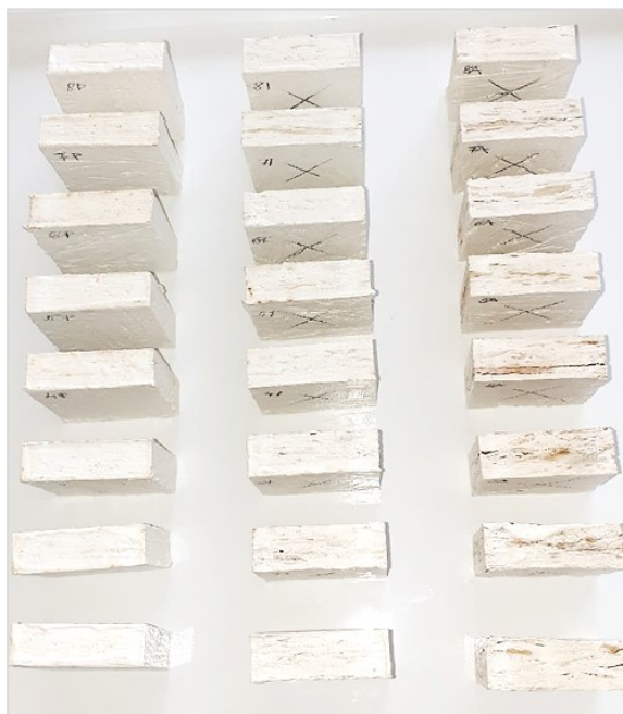
Obrázek č. 16: Rozdílná míra poškození 3 druhů povrchových úprav aplikovaných na vzorky OSB desky po zkoušce cyklováním [Zdroj: Vlastní zpracování]
