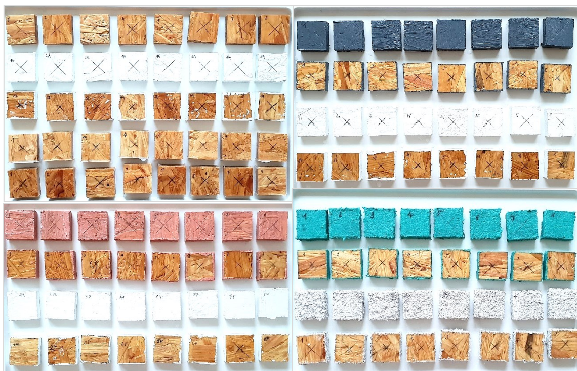
Obrázek č. 2: Zkušební vzorky pro zkoušku stanovení bobtnání po uložení ve vodě (8 kusů v surovém stavu a 2 sady s povrchovými úpravami – 136 kusů) [Zdroj: Vlastní zpracování]
