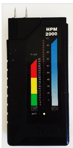
Obrázek č. 14: Vlhkoměr používaný při nedestruktivní zkoušce vzlínání [Zdroj: Vlastní zpracování]
