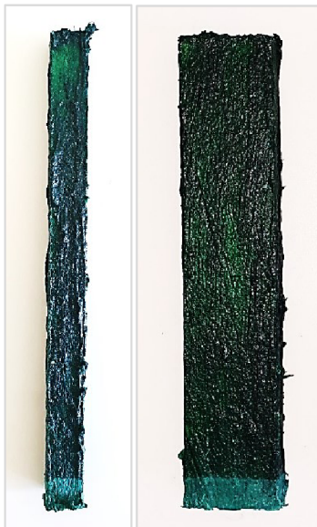
Obrázek č. 19: Vzorky opatřené povrchovou úpravou 2 – jednosložková HI stěrka při obou variantách zkoušky vzlínání [Zdroj: Vlastní zpracování]
