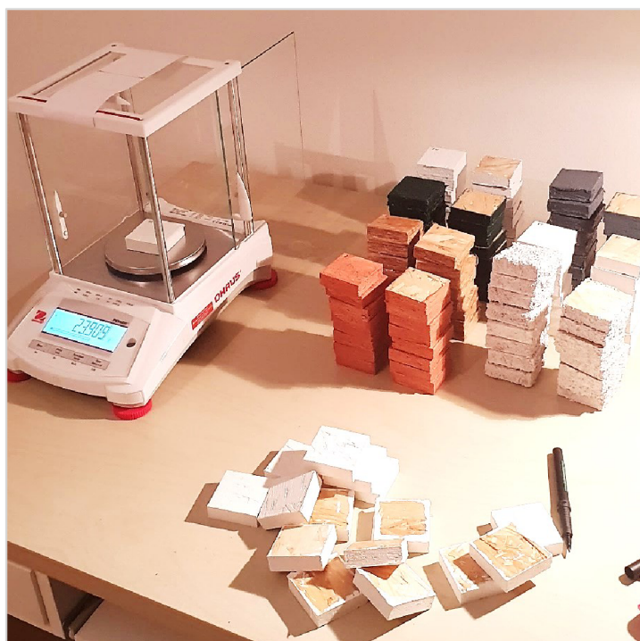
Obrázek č. 5: Vážení zkušebních vzorků velikosti 50 × 50 mm při ověřování dosažení konstantní hmotnosti
