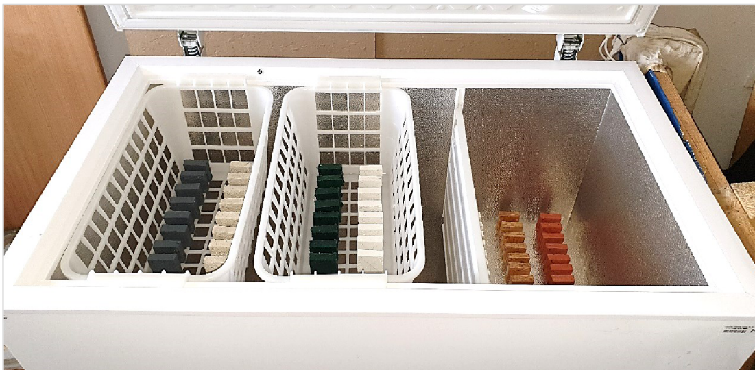
Obrázek č. 9: Zkušební vzorky umístěné v mrazničce při zkoušce cyklováním [Zdroj: Vlastní zpracování]
