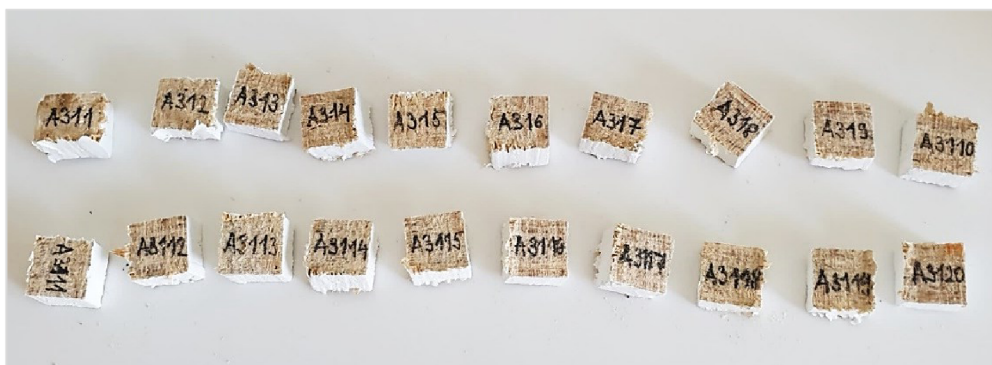
Obrázek č. 13: Rozřezaný zkušební vzorek po destruktivní zkoušce vzlinání [Zdroj: Vlastní zpracování]
