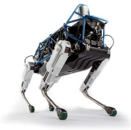
Obr. 1: Čtyřnohý robot SPOT CLASSIC od společnosti Boston Dynamics [8]
