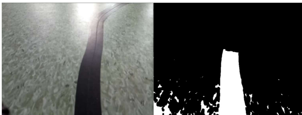
Obr. 25: Obraz z kamery při testování první varianty v situaci, kdy se čára leskla, originál (vlevo) a po zpracování (vpravo)
