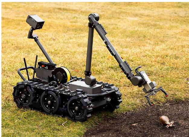
Obr. 2: Mobilní robot Centaur využíván americkou armádou pro dálkové monitorování, průzkum, odstraňování trosk, vyklízení tras a likvidaci bomb [9]
