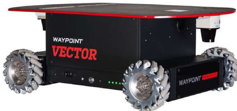
Obr. 4: Mobilní robot Vector s technologií všesměrových kol [11]
