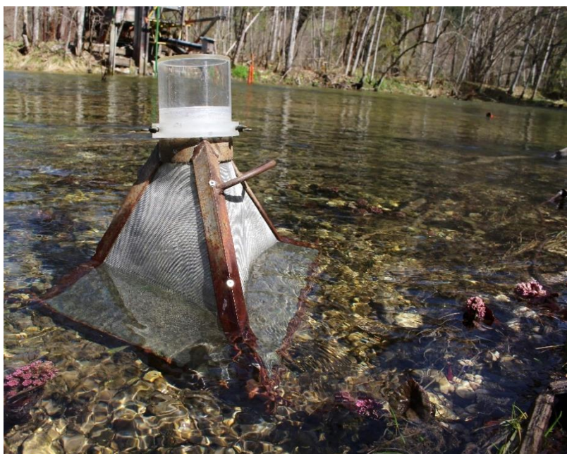
Obr. 9: Emergenční pyramidová past v potoce Oberer Seebach (Foto: Bočková 2018)
