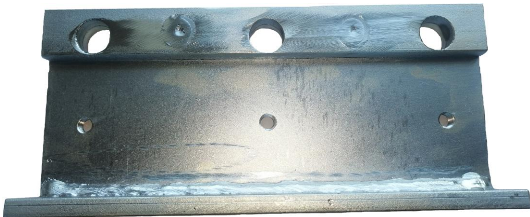
Obr. 18 Galvanicky povlakované vedení.
