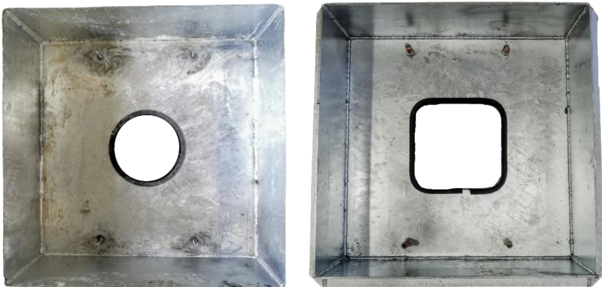
Obr. 22 Zástavbové vany před inovací (vlevo) a po inovaci (vpravo).
