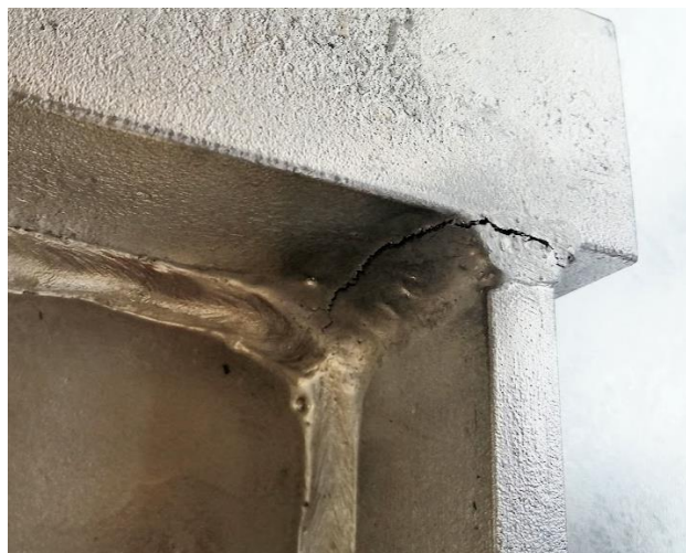
Obr. 17 Prasklý svar po rovnání.
