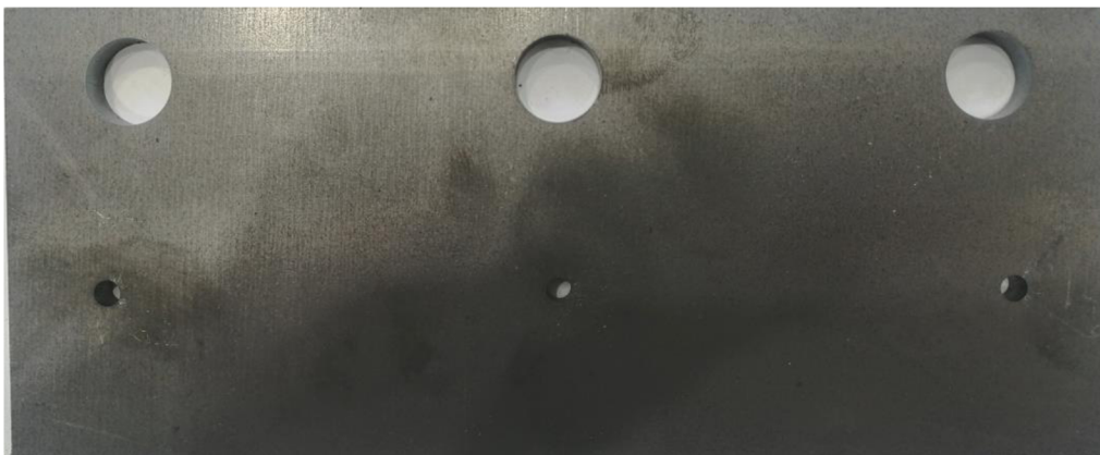
Obr. 5 Příklad výpalku bez obrábění – VEDENÍ.
