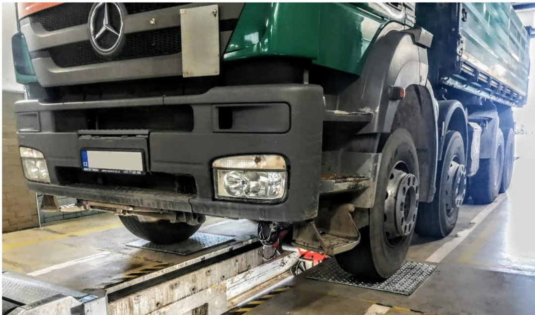
Obr. 21 Montážní zkouška nainstalovaných testerů na nákladní lince STK.
