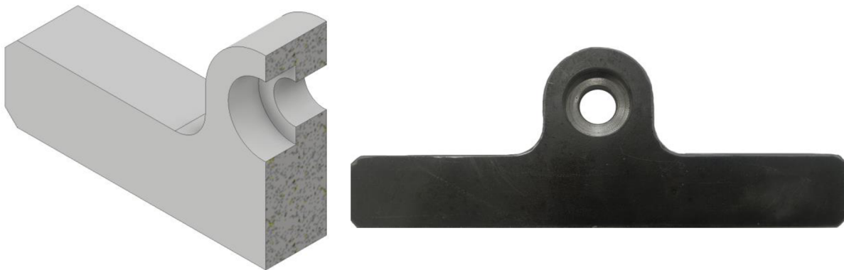
Obr. 9 Domek desky po obrobení s 3D modelem a skutečnou součástí.
