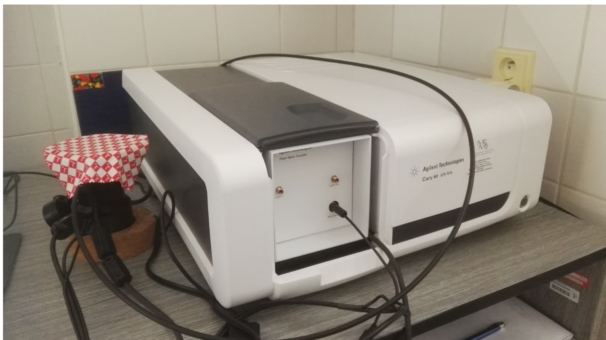
Obrázek 18: UV-VIS spektrometr Cary 60 s reflektančním nástavcem [38].
