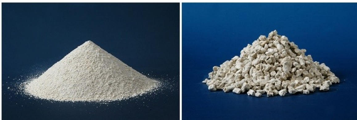
Obrázek 10: Vlevo: mletý kaolin, vpravo: kaolin ve formě nudliček [32].
