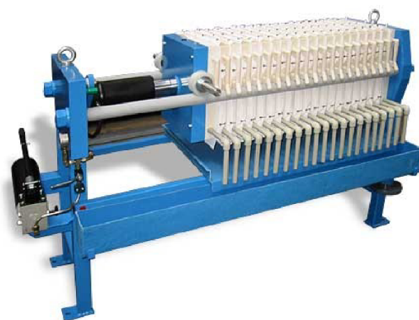
Obrázek 9: Kalolis sloužící k odvodu filtrátu a separaci kalu (kaolinu) [31].
