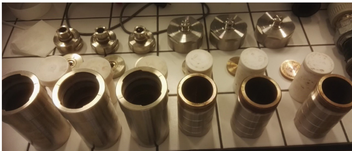
Obrázek 14: Rozložené autoklávy, nahoře k vidění uzávěry, pod nimi těžítka, teflonové vložky a samotné autoklávy.
