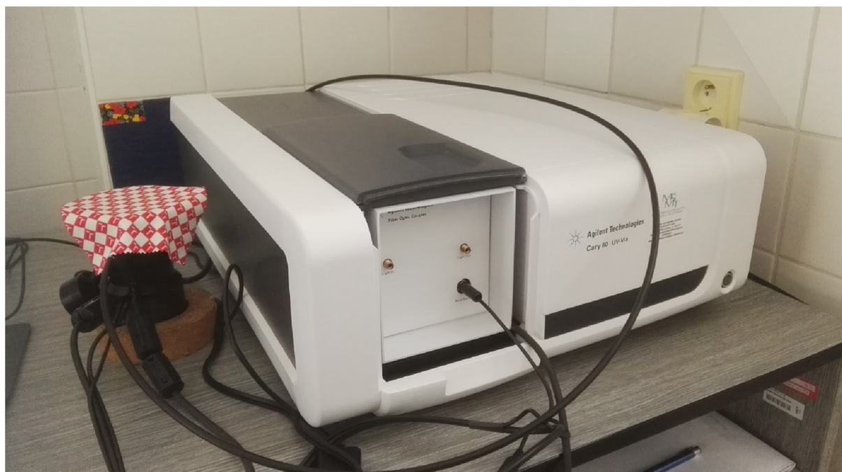
Obrázek 18: UV-VIS spektrometr Cary 60 s reflektančním nástavcem [38].
