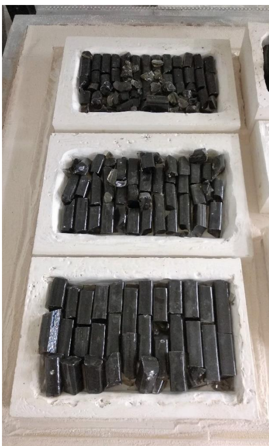
Obrázek 29. Formy s naloženým sklem připravené k tavbě
