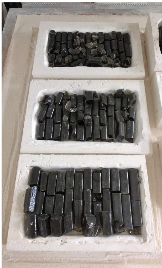
Obrázek 29. Formy s naloženým sklem připravené k tavbě
