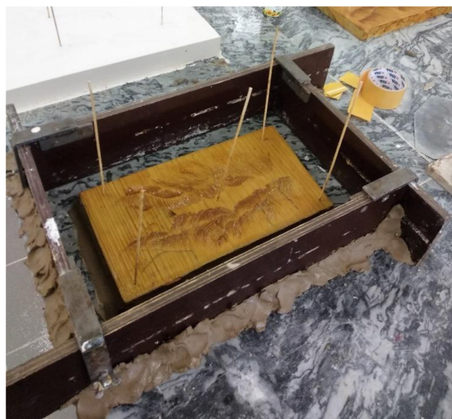
Obrázek 27. Model s dřevěnou ohrádkou připravený na zalití do sádry
