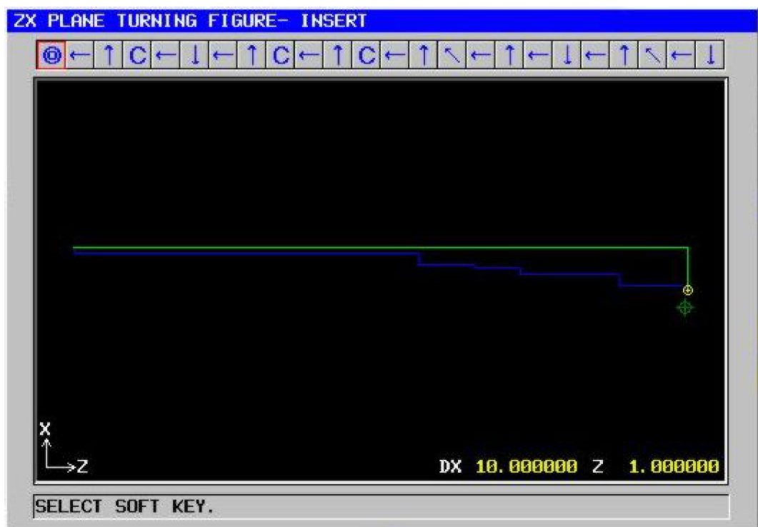
Obr. 6.2 FS53E00 – kontura pro pravou stranu hřídele
