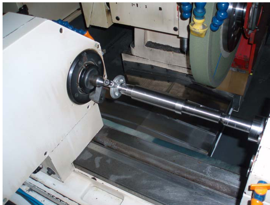
Obr. 1.4. Bruska STUDER S33 – Ukázka upnutí broušené hřídele FS53E00 mezi hroty s unášecím srdíčkem.
