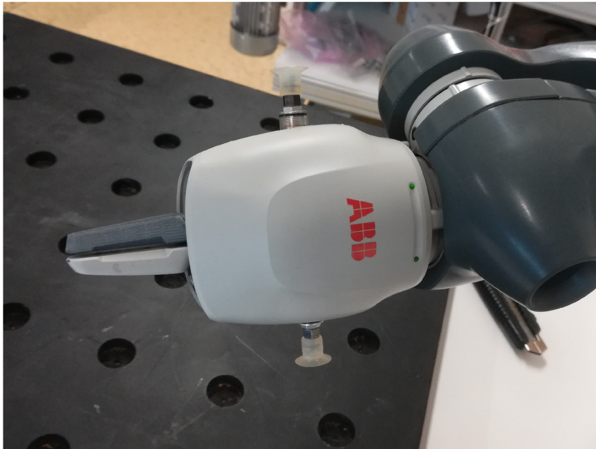
Obrázek 4.2: Efektor použitého kobota YuMi
