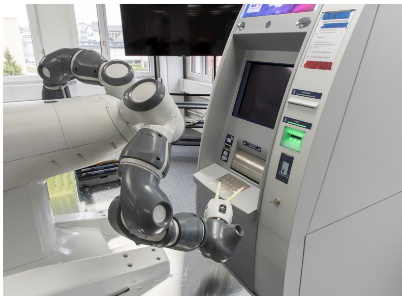
Obrázek 3.6: Testování automatů ATM pomocí YuMi [37]
