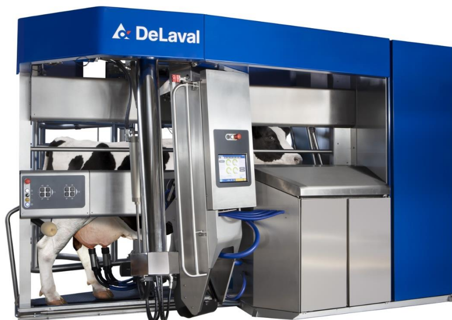
Obrázek 1.5: Dojící robot – DeLaval (DeLaval, 2023).
