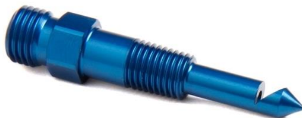
Obrázek 22: Vstřikovač pro použití v suchém systému vstřikování NOS [14]
