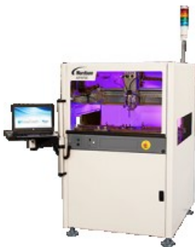
Obrázek 10: Lakovací systém Zdroj: Elitronic s.r.o.
