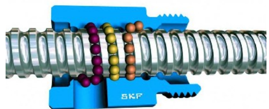
Obr. 27: Řez kuličkovým šroubem a maticí (fa SKF)
