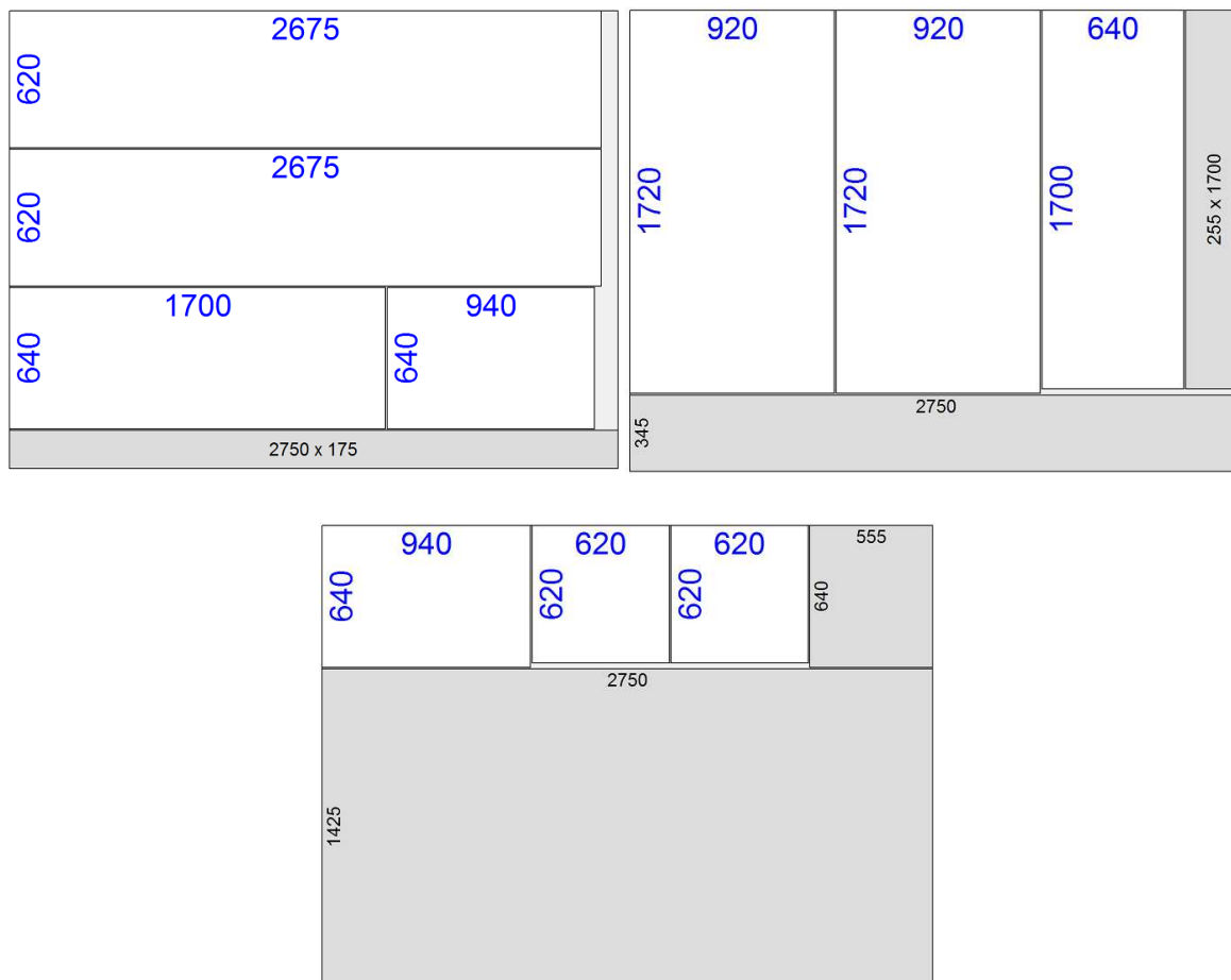
Obr. 9.01 Nářezový plán pro DTD surovou tl. 18 mm – formát 1-3
