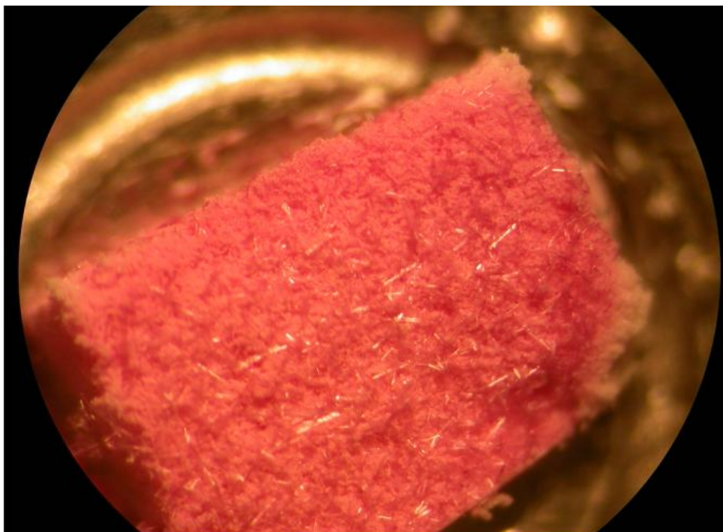
Obrázek 12: Vzorek oeninu nanesený na plátku methakrylátovém monolitu při 40x zvětšení optického mikroskopu.
