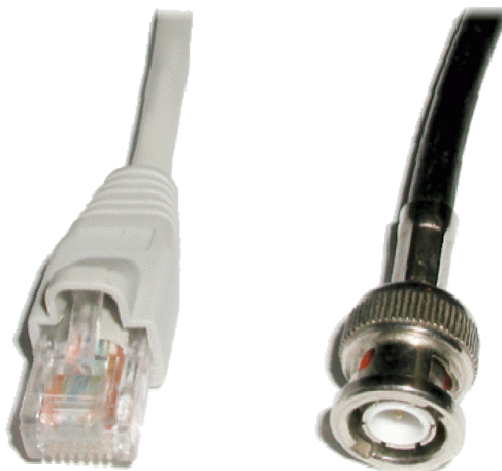
Obrázek 11 - vlevo konektor RJ-45, vpravo BNC konektor
