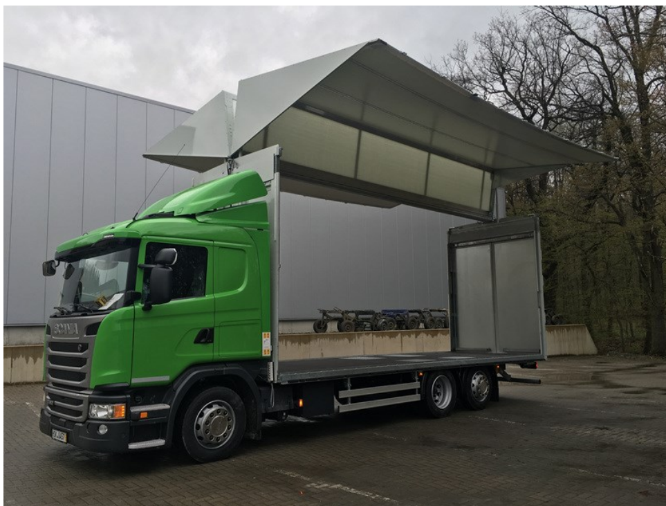
Obr. 3.7 Scania G440 s hydraulickými bočnicemi
