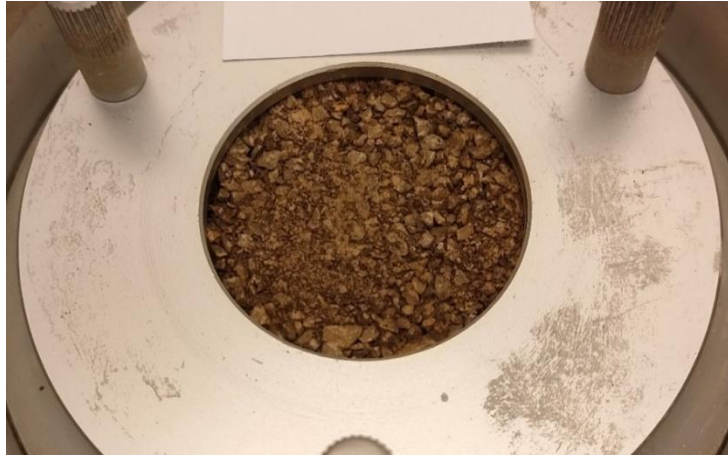
Obr. 7 Vzorek v prstenci před zkouškou, d = 50 \text{ mm} , v = 20 \text{ mm}
