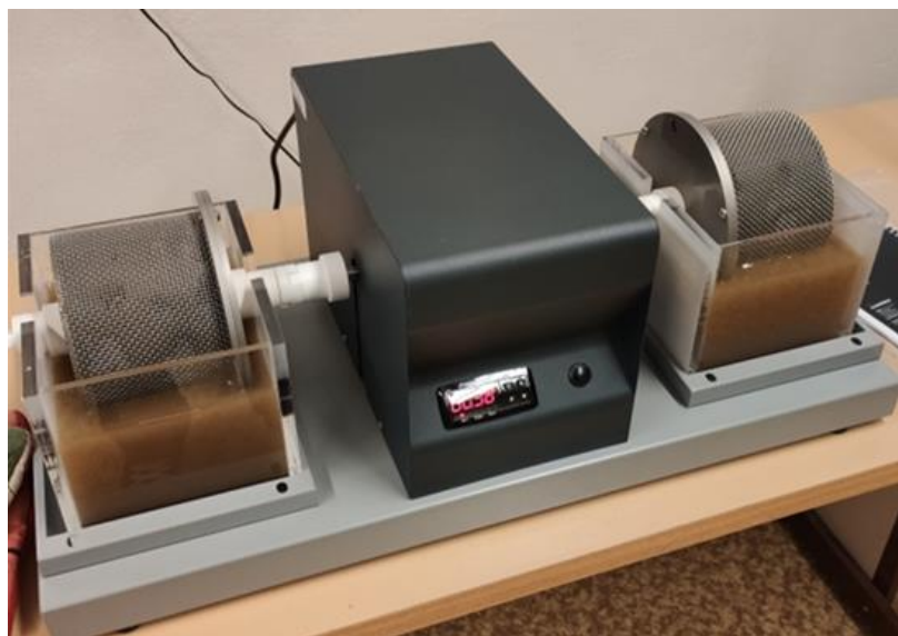
Obr. 2 Přístroj na Slake durability test – Ústav geotechniky Fakulta stavební VUT v Brně
