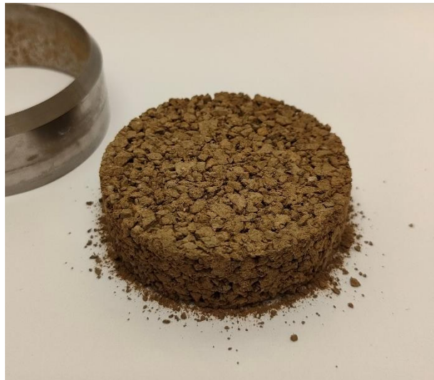
Obr. 8 Vzorek po zkoušce stlačitelnosti, d = 50 \text{ mm} , v = 20 \text{ mm}
