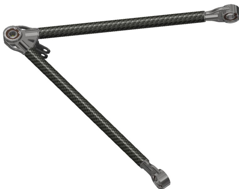
Obr. 23 – Ukázka koncepce provedení nového řešení zavěšení ramen [vlastní]
