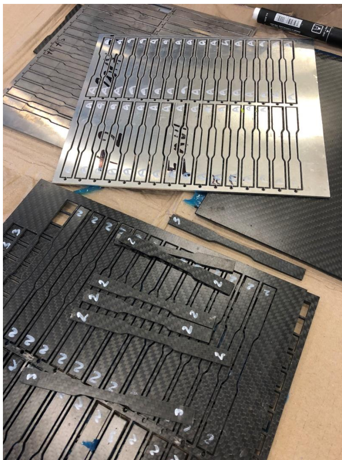
Obr. 14 - Ukázka vyříznutých vzorků pro tahovou zkoušku [vlastní]
