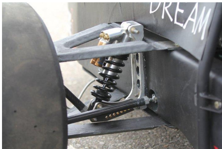
Obr. 4 - Speciální tvar ramen z uhlíkových vláken [6]
