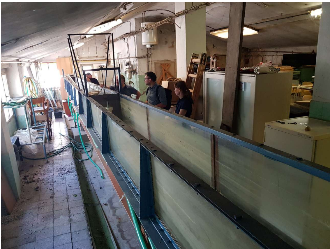
Obr. 3 Pohled na stávající sklopný měrný žlab v jednopodlažním objektu laboratoře
