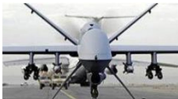
Obrázek 26 MQ-9 Reaper- Honeywell turboprop 671 kW [27]
