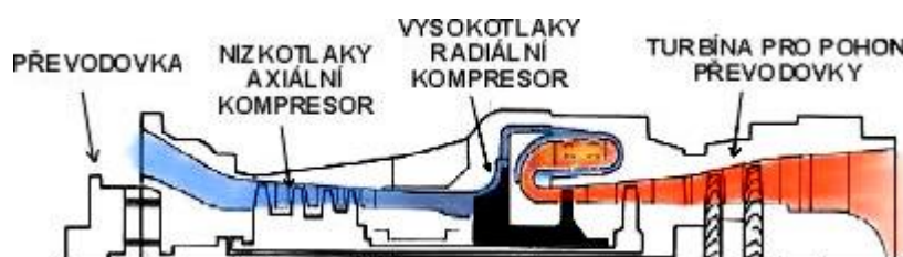
Obrázek 20 Turbo hřídelový motor [17]
