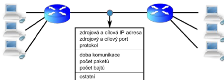
Obrázek 2.3: Princip technologie NetFlow
