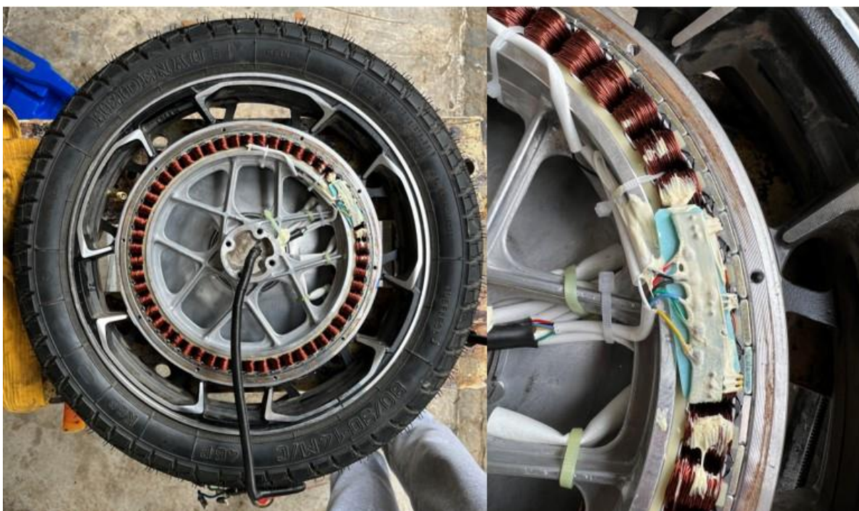
Obrázek 9 Motor S22 Pro a umístění hallova senzoru [9]
