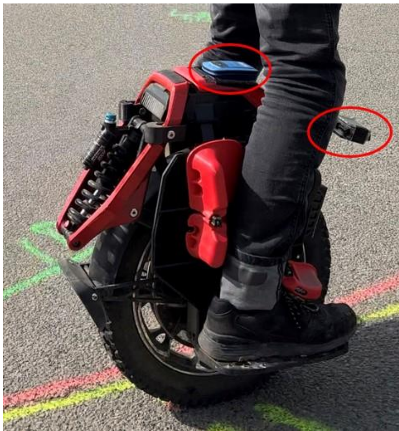
Obrázek 51 Umístění měřících přístrojů na jednokolce [9]
