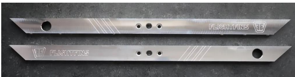
Obrázek 26 Profil rámu onewheel [21]
