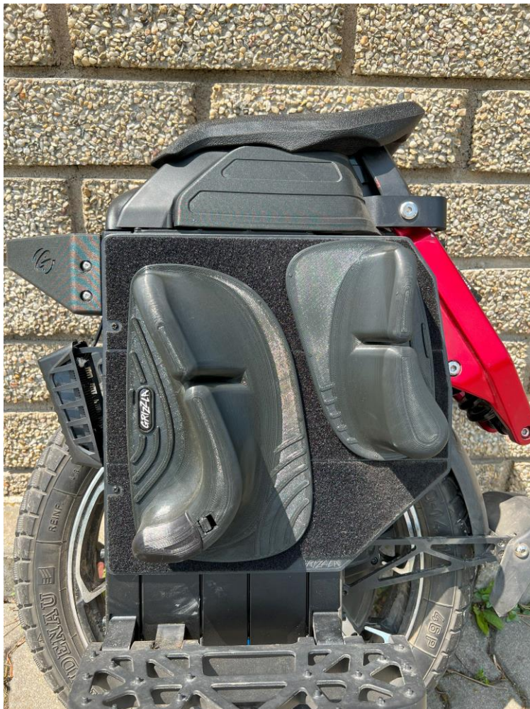
Obrázek 17 Umístění powerpadů na jednokolce Kingsong S22 Pro [9]
