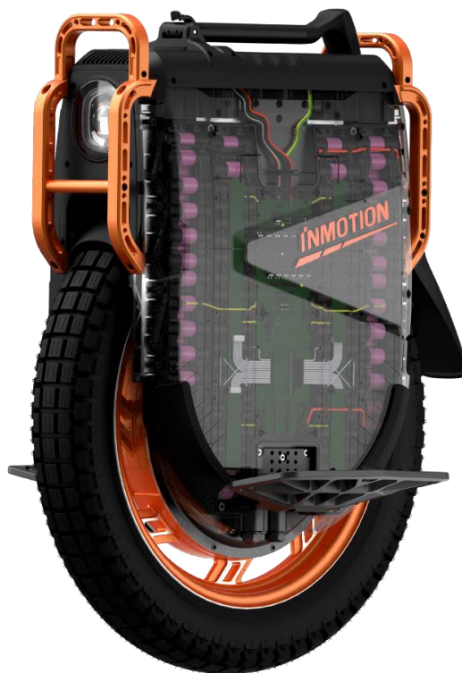
Obrázek 5 Inmotion V13 uložení akumulátoru [6]
