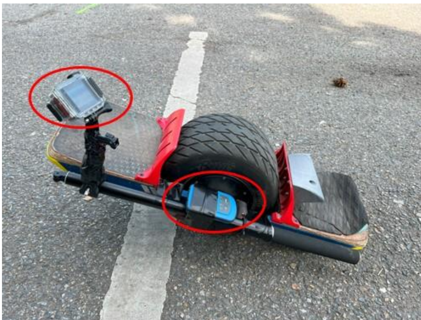
Obrázek 41 Upevnění kamery a Vbox na onewheel [9]
