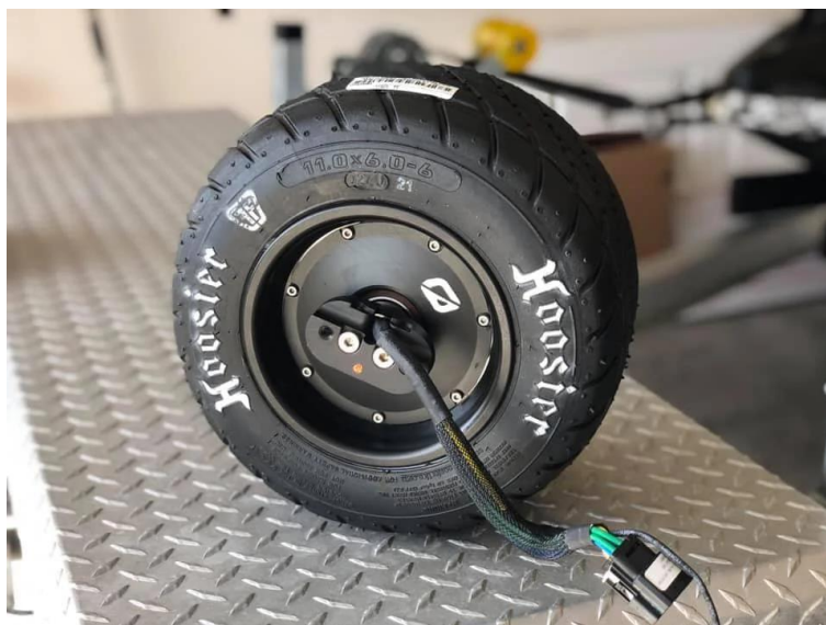
Obrázek 29 Pneumatika na Hyper Core motoru [24]
