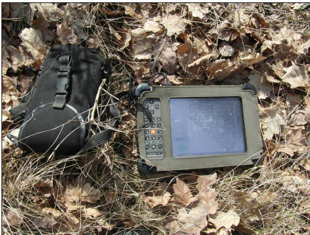
Obr. 27 Terénní počítač s Field-Map softwarem.
