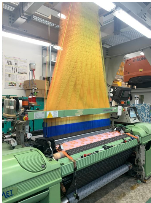
Obr. č. 25 – Tkáčsky stroj SOMET s elektronickým žakárovým prešlupným zariadením Stäubli
