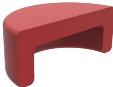
Obr. 44 Řez podložkou pro vymezení ventilové vůle
