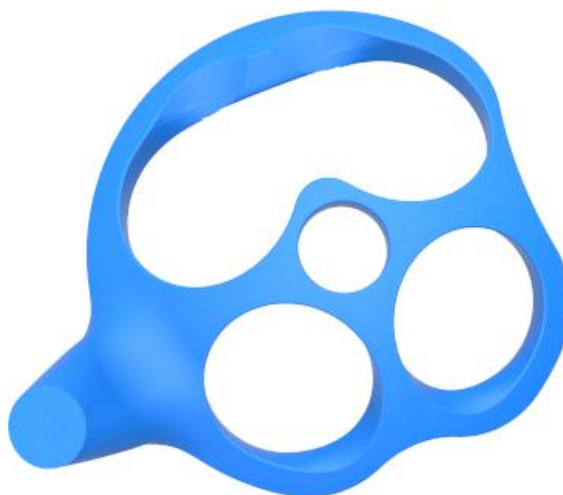
Obr. 60 Spalovací prostor - pohled 1
