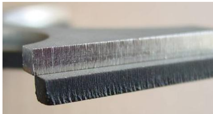
Obr. 25 Porovnání řezů při použití kyslíku a dusíku [10].
