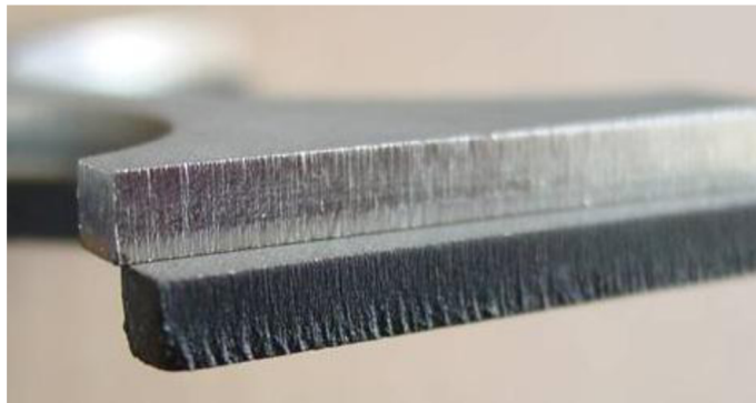
Obr. 25 Porovnání řezů při použití kyslíku a dusíku [10].
