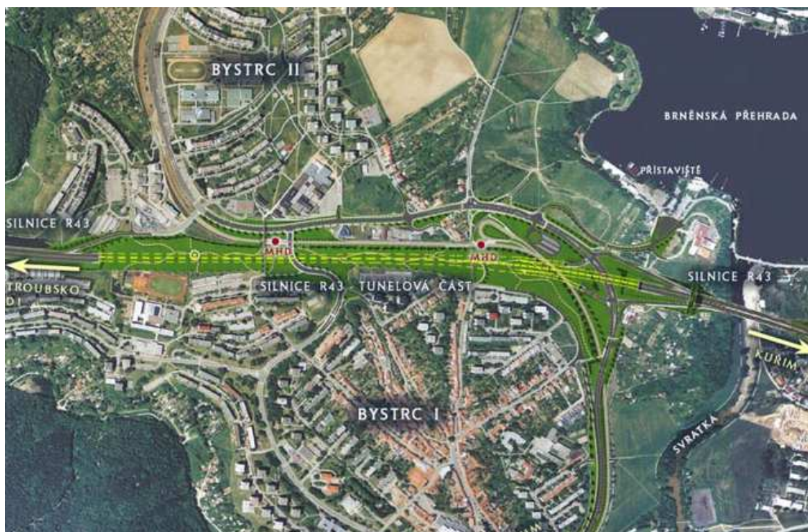
Obr. č. 40 Detailní podoba trasy v území Bystrce, vedená převážně v tunelovém tělesu [29]
