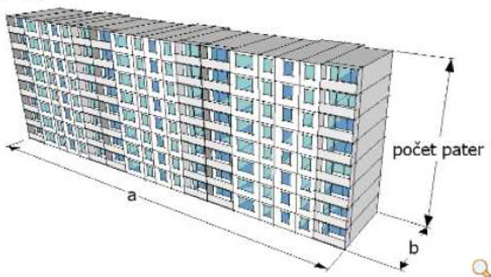
Obr. č. 10 3 D vizualizace panelového systému G 57. [13]
