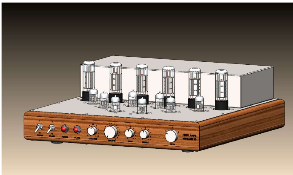
Obr. 4-1 3D model navrhovaného zesilovače
